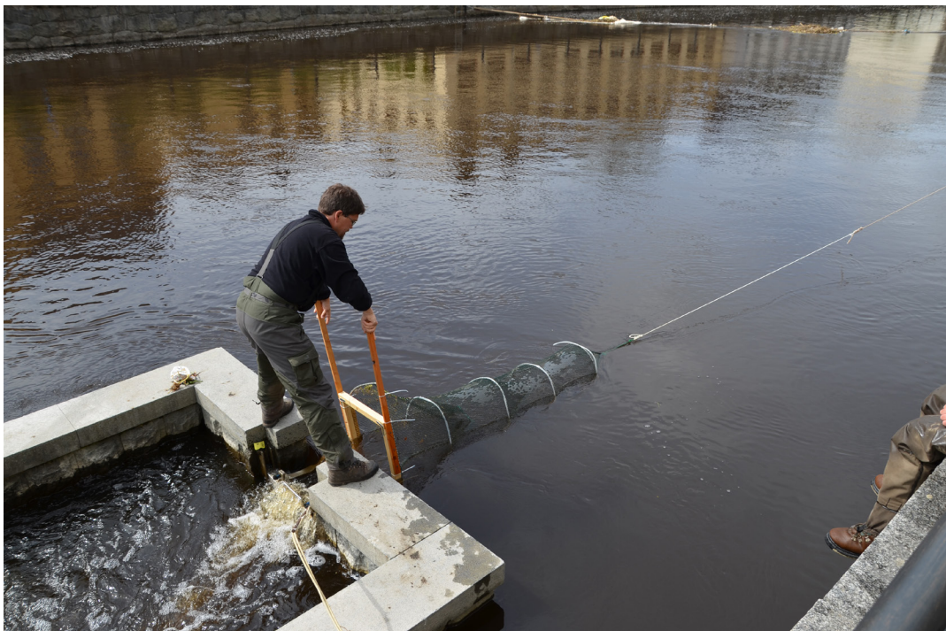
Bild 5. Fisk fångades i en specialkonstruerad ryssja vid uppströmpassage av fisk genom fiskräknaren.
