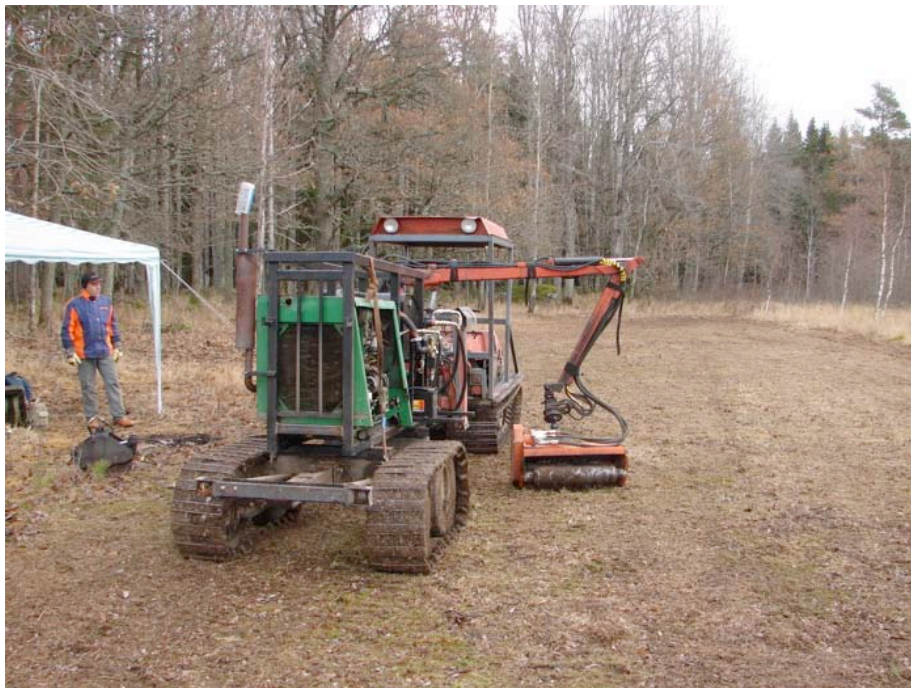
En mindre traktor (Terri) transporterades över till Gässön på en pråm. Videbuskar och sly röjdes på älvängen, därefter frästes en yta på ca 1 ha som sedermera slogs under hösten 2008. . Foto Pär Eriksson
