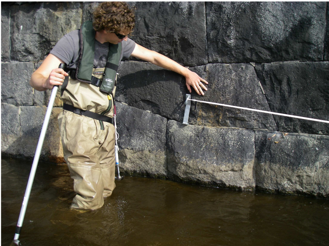
Figur 1. Transekterna markerades med glasfibermåttband som fästes med bergkil i stensättningen.
