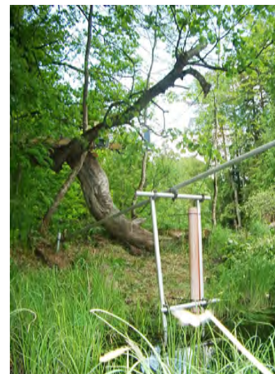
Pegel med rör som vattennivågivare samt logger och solfångare. Foto Jesper Hansson
