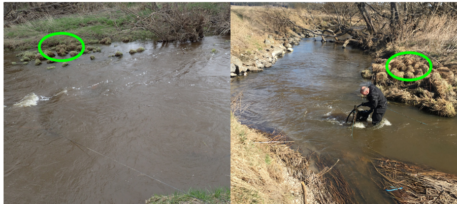
Bild 2. Cirkelantennen som användes vid Vänsjöbro i Örsundaån fungerade väl under det relativt låga vattnet 2017 (bilden t.h. 19 april). Under 2018 var vattnet avsevärt högre varför fisken tämligen enkelt kunde passera vid sidan av antennen (bilden t.v. 28 april) vilket sannolikt förklarar de få registreringarna av märkt fisk. De gröna ellipserna visar ungefär samma tuvor.
