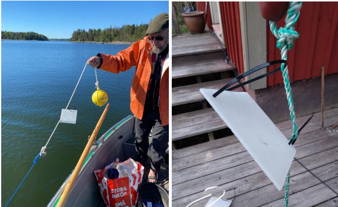
Musselplatta (vit och kvadratisk). På grunda lokaler placerades en platta ut och på djupare lokaler (mer än 3–4 m) placerades två plattor ut. Plattorna fästes med buntband i en vinkel om ca 45°.
